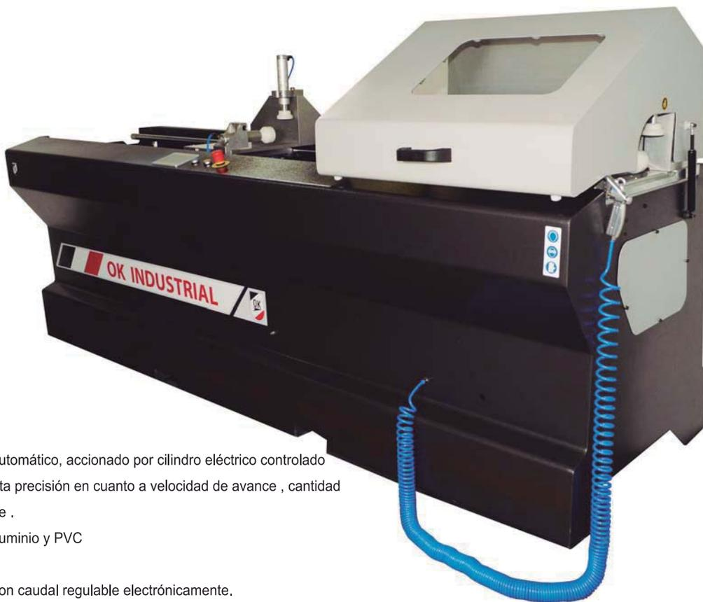
Corte con cabezal ascendente de avance automático, accionado por cilindro eléctrico controlado por servomotor, lo que permite control de alta precisión en cuanto a velocidad de avance, cantidad de avance (alto de corte) y fuerza de avance.
