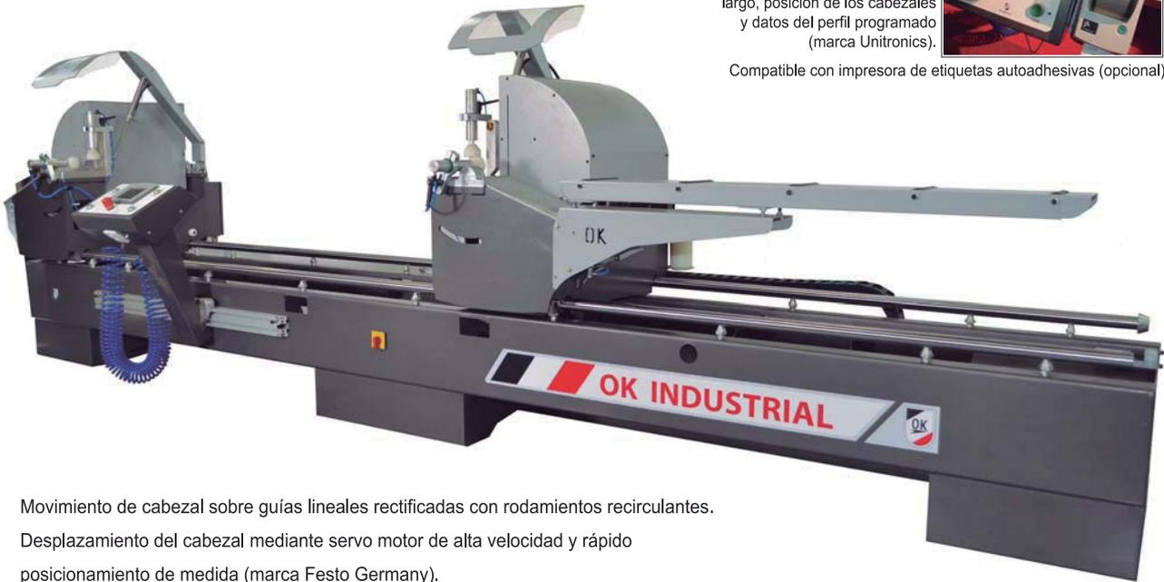
Movimiento de cabezal sobre guías lineales rectificadas con rodamientos recirculantes.
