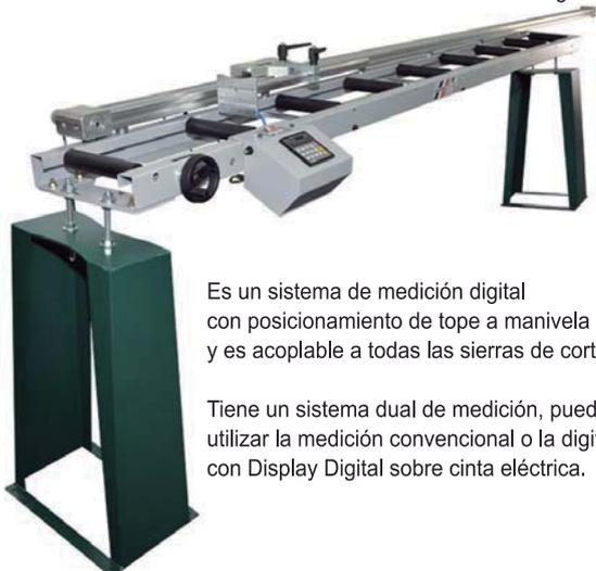
Es un sistema de medición digital con posicionamiento de tope a manivela y es acoplable a todas las sierras de corte.
